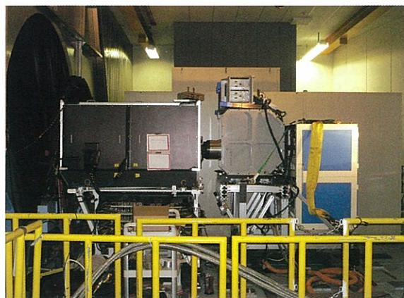
図2 ナスマス焦点に設置したAO(左、黒い箱)とナスマス用に改造した観測装置IRCS(右、灰色)。レーザー室(3m × 5m)が背後にあります。
